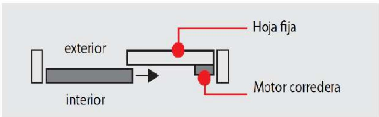
Configuración de la Corredera AE 9083 para la motorización.
