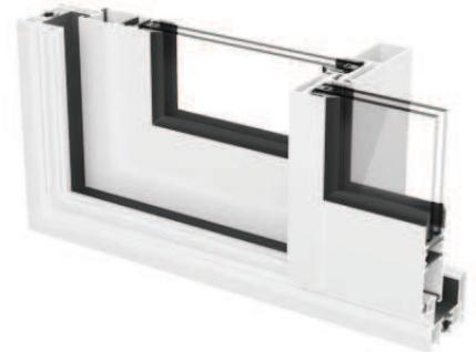
Serie corredera dotada de Rotura de Puente Térmico, diseñada para conseguir un cambio en la estética de la ventana, donde el cruce central únicamente tiene 30mm. de aluminio visto. Algunas características de la serie son:
