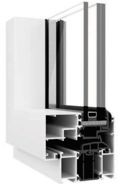
Serie practicable con rotura de puente térmico y canal 16, diseñada para conseguir un cambio en la estética de la ventana, tanto por el exterior donde solamente se ve el marco, como por el interior donde al desaparecer el junquillo queda una superficie continua.
